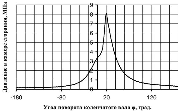
**Рис. 3.** Зависимость изменения давления  $P$  (МПа) от угла поворота вала  $\phi$ . Топливо – водный раствор этанола (45%), угол опережения зажигания 10 град. п.к.в
