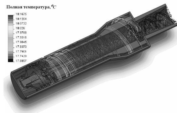
Рис. 3. Линии тока в проточной части регулятора
