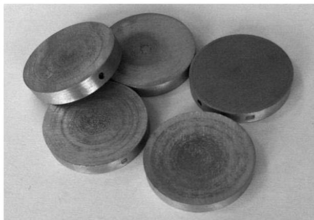
Рис. 1. Образцы из сплава АК12
