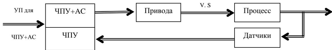
Адаптивная система управления (АдСУ) температурно-силовым режимом обработки выполнена на базе ЧПУ и состоит из программного обеспечения, входящего в состав СПО и датчиков регулируемых параметров. Предназначена для использования на станках токарной группы.
