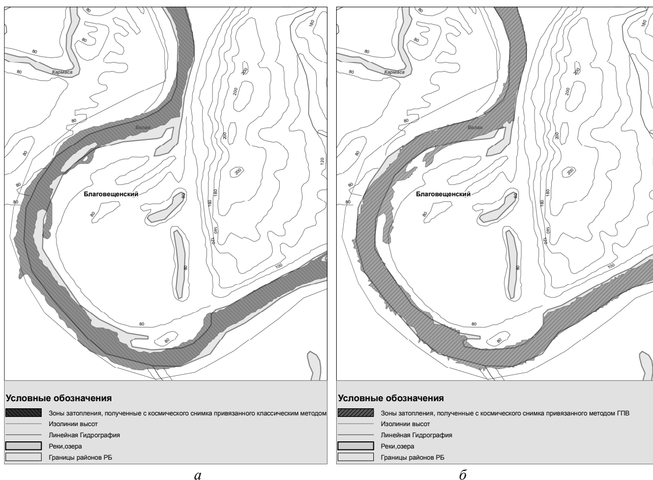
Рис. 6. Различие между зонами затопления, полученными с космического снимка, привязанного классическим способом (а), и зонами затопления, полученными с космического снимка, обработанного с использованием метода ПЗК (б)
