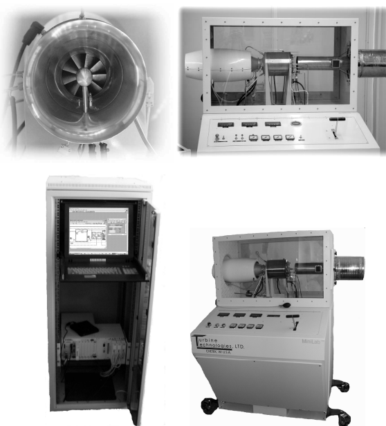
Рис. 2. Двигатель SR-30 и стойка автоматизации стенда MiniLab
