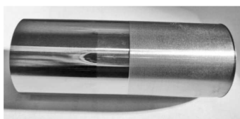
Рис. 2. Тестовая деталь. Сталь 30X13 ( \sigma_{0,2} \geq 440 МПа, \sigma_B \geq 650 МПа, \delta_s \geq 16\% , \psi \geq 55\% , 27 HRC max )
