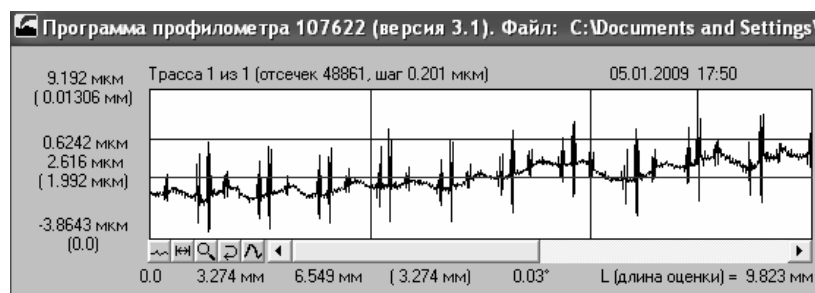
Рис. 2. Профилограмма поверхности детали после нанесения частично-регулярного микрорельефа (ЧРМР)
