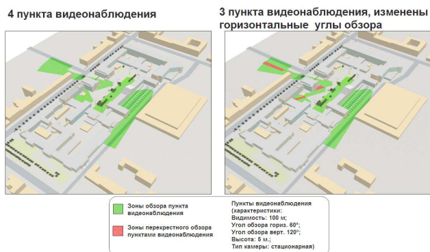
Рис. 4. Выбор мест вариантов размещения оборудования видеонаблюдения на примере трехмерной модели Вузгородка УГАТУ
