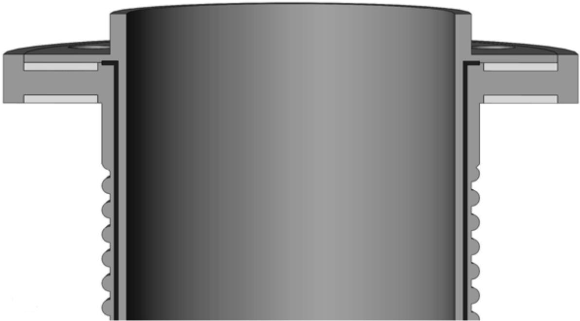
**Рис. 5.** Металлические пластины жесткости, интегрированные в верхнюю часть композитного корпуса
