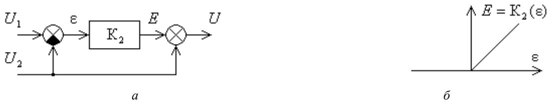
Рис. 5. Эквивалентная нелинейная структура АС: а – структурная схема селектора; б – нелинейность типа «ключ»
