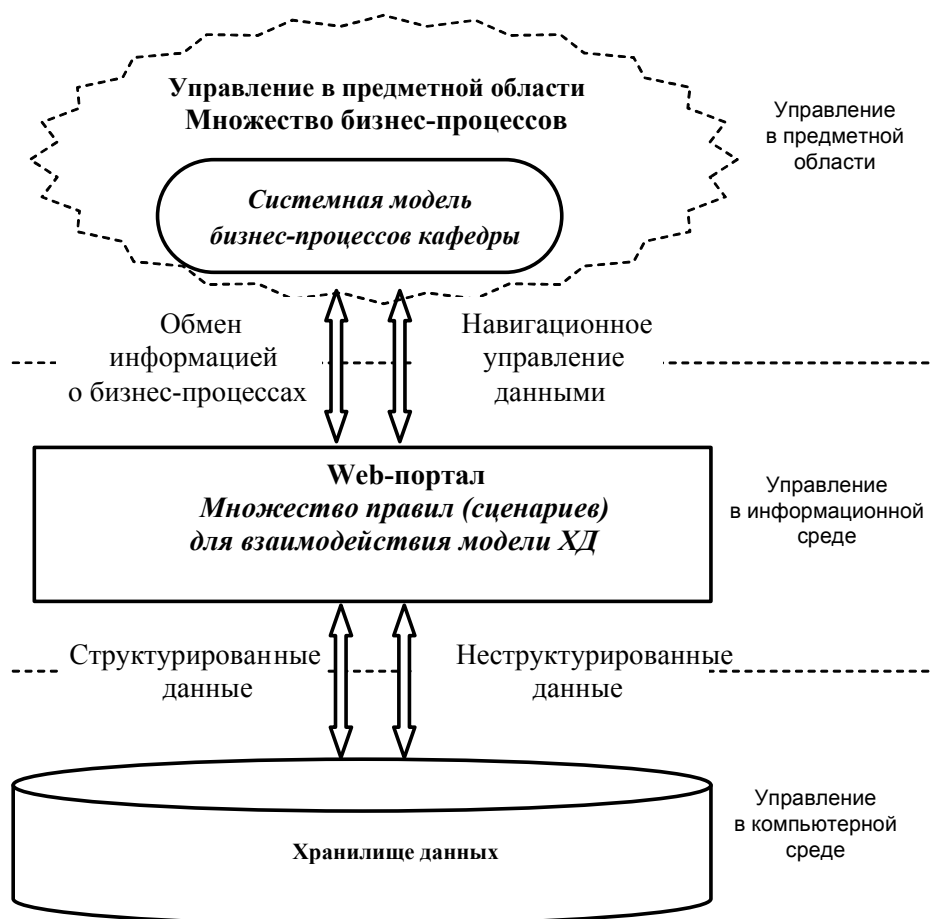
Рис. 4. Структура программного обеспечения web-портала
