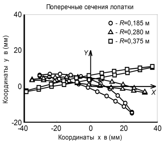
Рис. 5. Заданные профили лопатки для трех сечений
