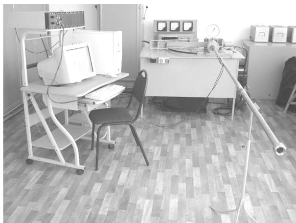
Рис. 10. Вид одноцикловой установки с трубопроводом и измерительной системой
