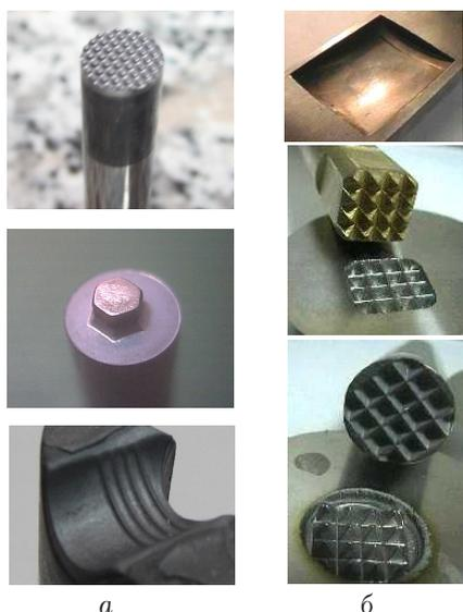
Рис. 12. Образцы деталей из порошковых (а) и нанокристаллических (б) материалов
