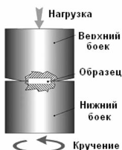
**Рис. 1.** Принципиальная схема интенсивной пластической деформации ИПДК
