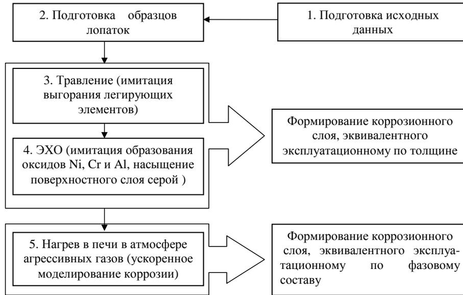
Рис. 3. Общая схема ускоренного моделирования высокотемпературной газовой коррозии образцов лопаток из жаропрочного сплава (типа ЖС6К)
