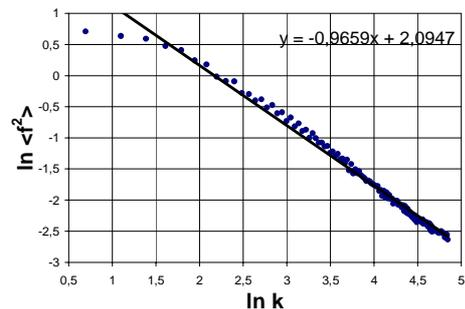
Рис. 2. Зависимость усредненного спектра  $\langle f^2 \rangle$  от радиального волнового числа  $k$
