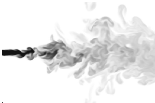
Рис. 4. Поле массовой доли топлива (этанол) Y_F = 0 \dots 0,6 к моменту \alpha_\Sigma = 45 , для цилиндра с V_h = 100 \text{ см}^3 и \eta_V = 0,42 из первого расчета; условия вдува ТВС без предкамеры
