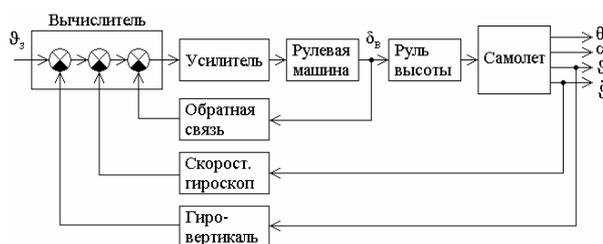
Рис. 1. Функциональная схема канала тангажа
