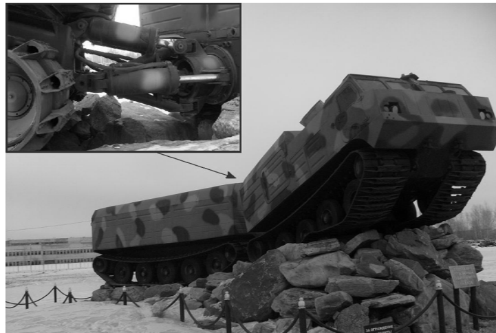
Рис. 1. Поворотно-сцепное устройство двухзвенного транспортера «Витязь»
