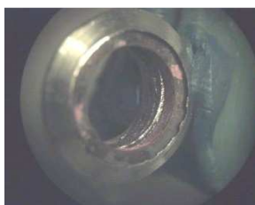
Рис. 2. Завальцовка и графлексовые шайбы после испытаний
