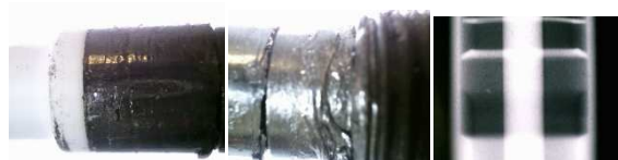
Рис. 4. Состояние макета с графлексом после испытаний и рентгенограмма узла (справа)
