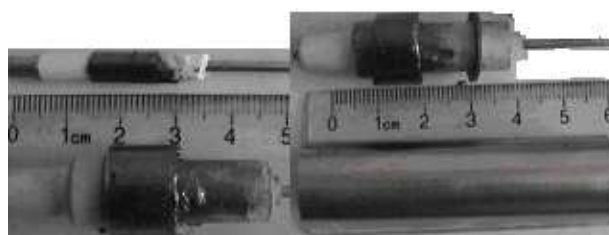
Рис. 5. Результаты дефектации свечей после испытаний
