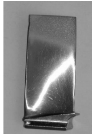
Рис. 3. Эрозионный износ рабочей лопатки компрессора 3 ступени без противозерозионного покрытия
