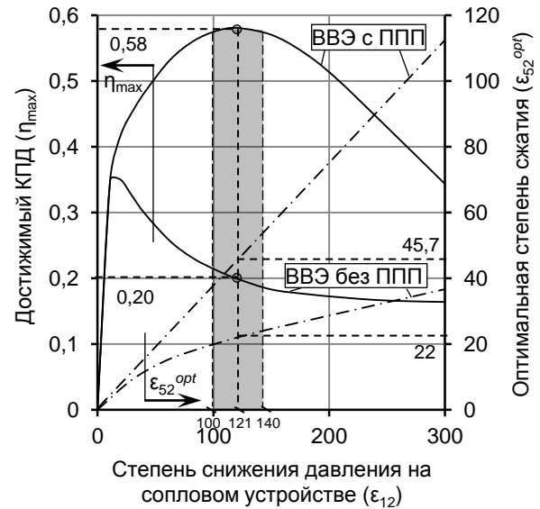
Рис. 8. Сравнение КПД и предельной степени сжатия ВВЭ с ППП и без него
