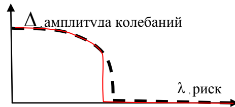
Рис. 9. Амплитудные характеристики систем различных типов: пунктирная линия – амплитудная характеристика симметричной системы при мягкой бифуркации; непрерывная – при рождении цикла скачком
