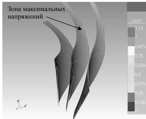
Рис. 8. Определение зоны максимальных напряжений по обратному коэффициенту запаса  $IRF$  в лопатке центробежного компрессора со структурой ( $90^\circ/0^\circ$ ) при повышенной температуре
