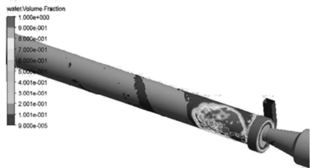
**Рис. 5.** Распределение объемной концентрации жидкой фазы в камере вихревой трубы
