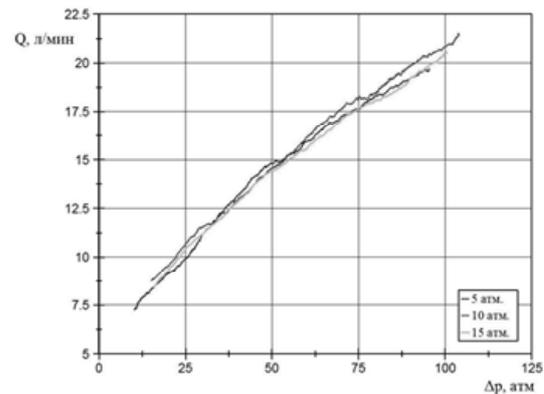
Рис. 2. Расходно-перепадные характеристики струйного элемента типа «сопло-сопло» при постоянном давлении на выходе и переменном давлении в струйной камере 5, 10, 15 атм
