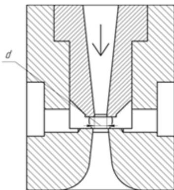
Рис. 1. Струйный элемент типа «сопло-сопло» (кавитатор):  $d_c = 1,6$  мм;  $\bar{d} = 1,25$ ;  $\bar{H} = 0,93$
