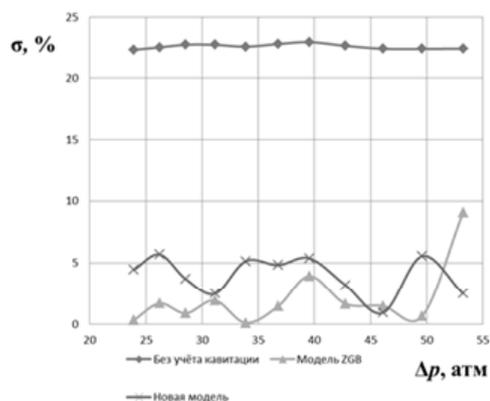
Рис. 4. Изменение погрешности в зависимости от перепада давлений
