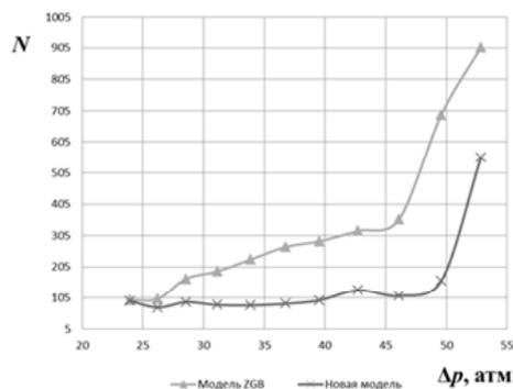
Рис. 5. Зависимость числа итераций, необходимых для получения решения, для новой численной модели кавитации и модели Zwart-Gerber-Belamri
