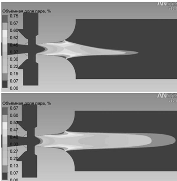
**Рис. 6.** Визуализация объемной доли пара для перепада давлений 39,5 атм: *a* – модель Zwart-Gerber-Belamri; *б* – новая численная модель кавитации (17)
