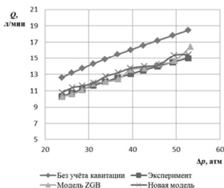
Рис. 3. Результаты численного моделирования в сопоставлении с экспериментом
