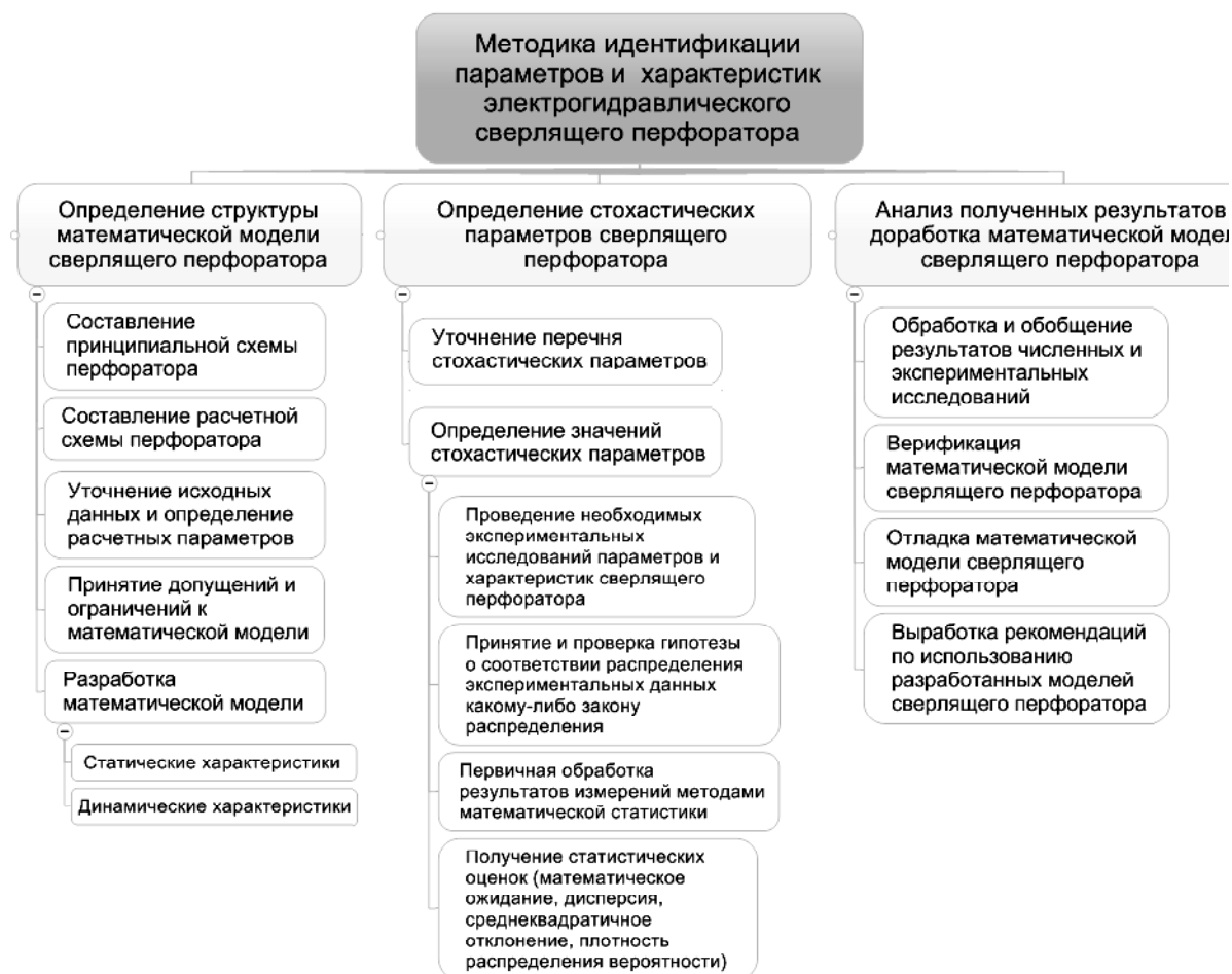
Рис. 1. ИСР идентификации параметров и характеристик сверлящего перфоратора
