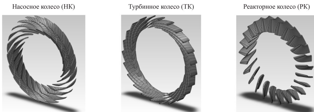
Рис. 5. Трехмерные модели лопастных систем ГДП
