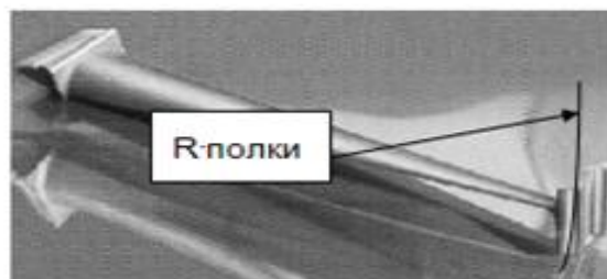
Рис. 1. Общий вид радиусных поверхностей полок турбинной лопатки газотурбинного двигателя ПС90 А: 1, 3, 5 – выступы, 2, 4 – впадины
