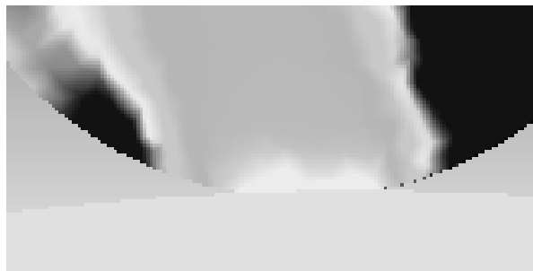
Рис. 5. Результаты расчета деформаций профиля вращающегося ролика (гладкий ролик) относительно лопатки
