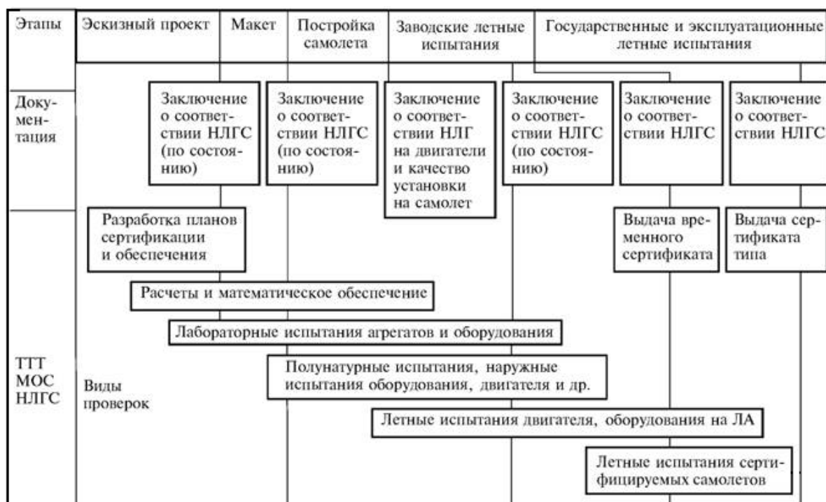
Рис. 2. Общая программа сертификации самолета Боинг-747 (ТТТ – тактико-технические требования, МОС – методы определения соответствия, НЛГС – нормы летной годности самолета)
