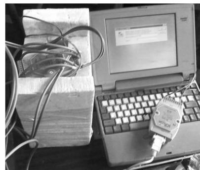
Рис. 5. Система измерения данных (модуль I-7018P вынут из теплоизолирующего бокса для наглядности)
