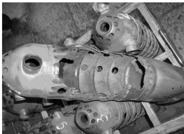
Рис. 4. Прогар жаровой трубы [6]
