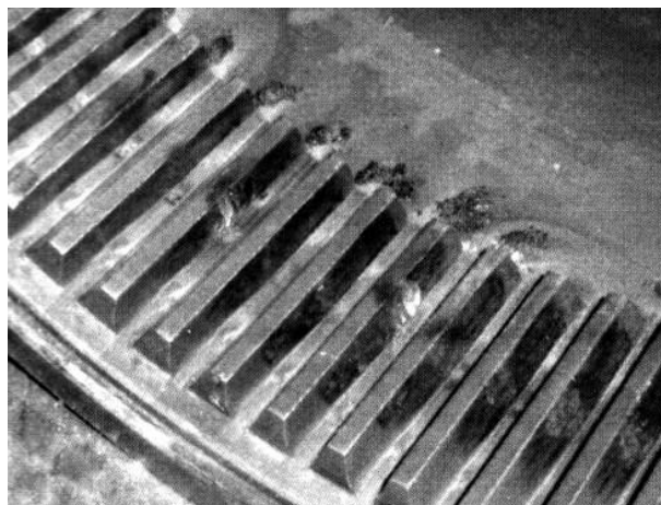
Рис. 5. Разрушение зубьев внутреннего зацепления (обоймы) муфты
