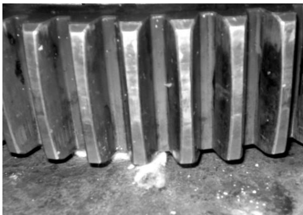
Рис. 3. Износ поверхностей зубьев зубчатой муфты
