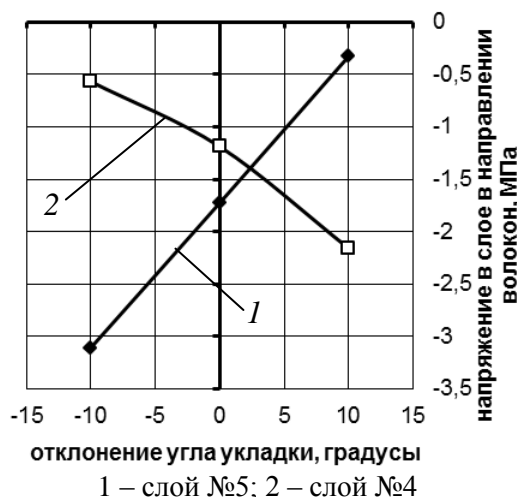
Рис. 4. Зависимость нормальных напряжений в слоях двухопорной 5-слойной балки от величины изменения угла укладки слоя № 5 от начального состояния ( 45^\circ )
