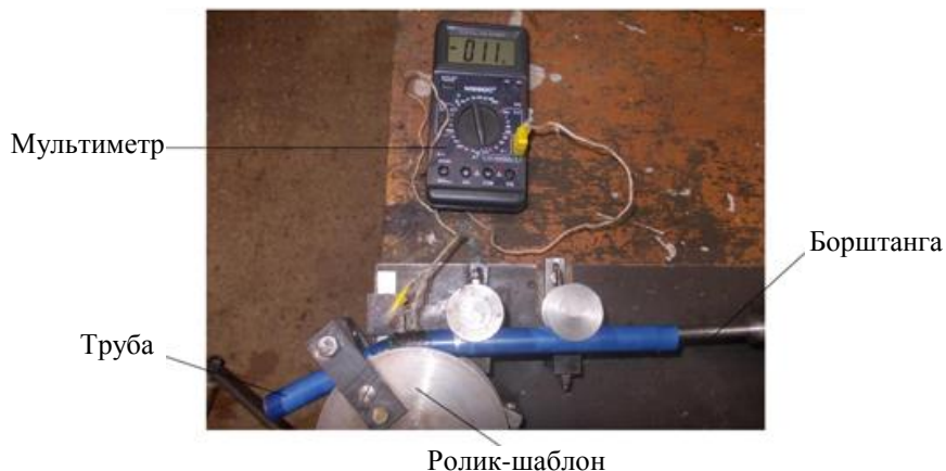
Рис. 6. Установка для гибки мелкокоразмерных труб с применением термопар
