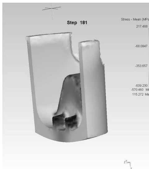
Рис. 3. Распределение главных напряжений в теле поршня
