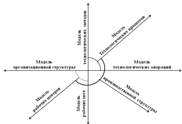
Рис. 2. Графическое представление статической интегральной модели производственного процесса
