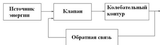
Рис. 1. Схема автоколебательной системы
