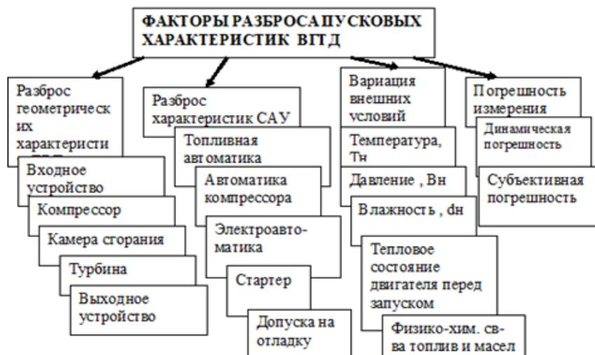
Рис. 1. Классификация факторов, вызывающих разброс пусковых характеристик
