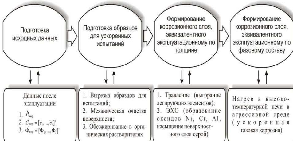
Рис. 2. Общая схема проведения ускоренных испытаний сопловых лопаток турбин на высокотемпературную газовую коррозию
