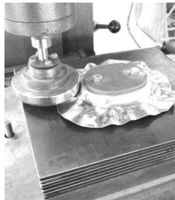
Рис. 3. Процесс формообразования полый неосесимметричной детали способом обкатки
