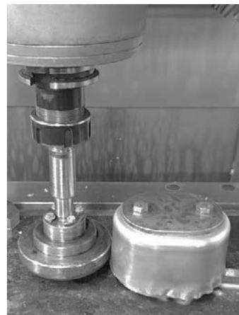
Рис. 4. Заключительная стадия формообразования полый неосесимметричной детали методом обкатки
