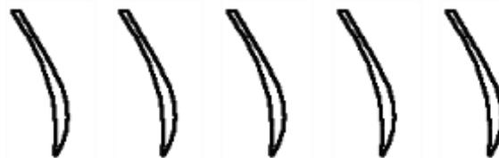
Рис. 1. Геометрия профиля лопатки решеток реверсивного устройства
