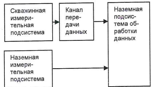
Рис. 4. Обобщенная структура измерительной системы
