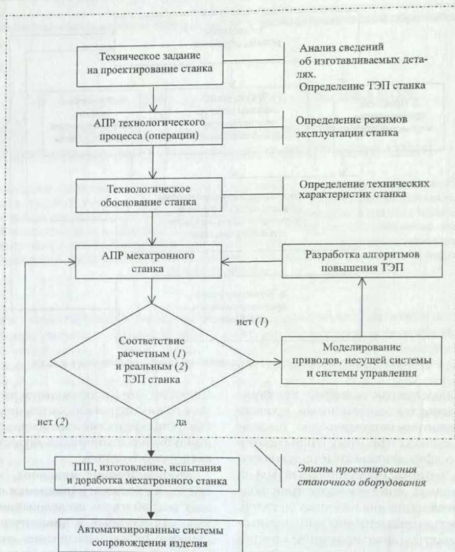
Рис. 2. Структура процесса создания мехатронного станочного оборудования
