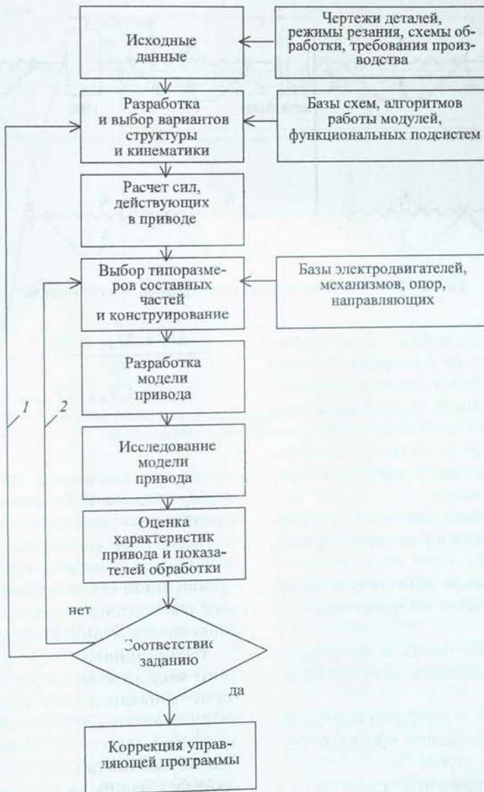
Рис. 3. Блок-схема алгоритма автоматизированного проектирования модуля подачи: 1, 2 — связи, учитывающие несоответствие по структуре и конструкции
