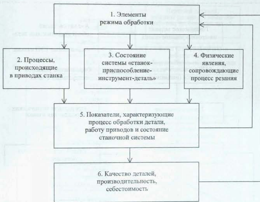
Рис. 1. Структурные связи управляемого процесса изготовления детали
