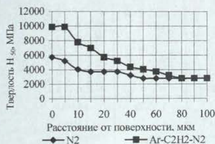
Рис. 5. Изменение микротвердости по глубине азотированного слоя стали 38ХМЮА после обработки несамостоятельным сильноточным диффузионным разрядом
