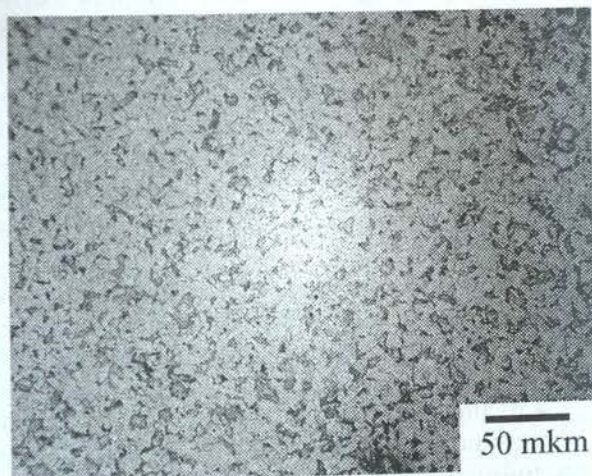
Рис. 10. 30XГСА — светлая закалка от T = 950^{\circ}\text{C} , P = 200 Па, I = 0,6 А, U = 500 В
