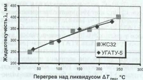
Рис. 9. Зависимость условно-истинной жидкотекучести сплавов от перегрева над температурой ликвидус
