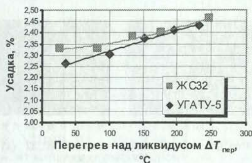
Рис. 7. Зависимость линейной усадки сплавов от перегрева над температурой ликвидус
