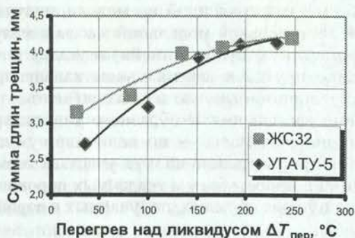
Рис. 8. Зависимость трещинопоражаемости сплавов от перегрева над температурой ликвидус
