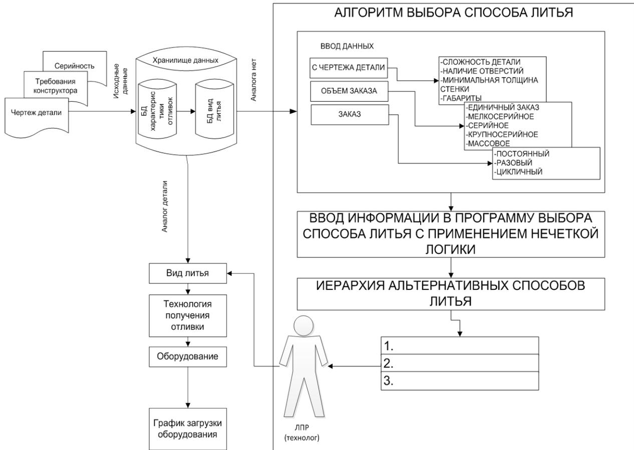
Рис. 1. Мнемосхема выбора способа литья с применением нечеткой логики
